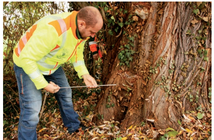
Baumkontrolleur Kay Ostwald hat 30 cm gemessen, die der Sondierstab ins morsche Holz eingedrungen ist.
