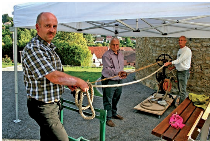
Beim Warturm demonstrierten Achim Schäfer, Klaus Geggus und Horst Bartholomä am „Tag des offenen Denkmals“, wie man auf einer Seiler-Bahn ein Seil herstellt. Foto: Roland Felleisen
