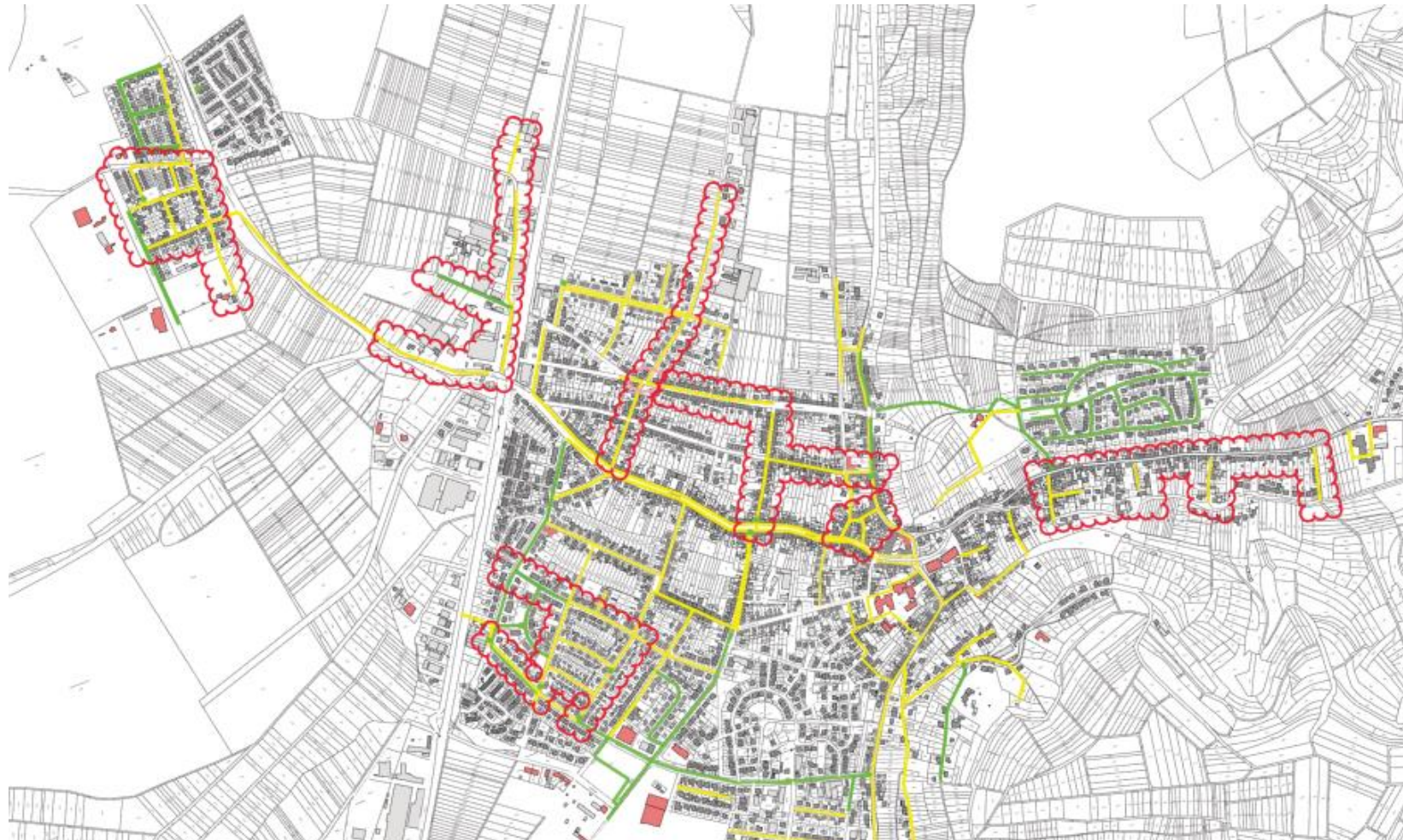
Übersicht der Rohrnetz-Maßnahmen Wasserversorgung/ Abwasserbeseitigung/ Straßensanierung
